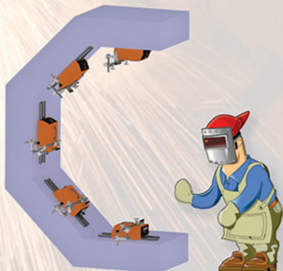
وضعیت حرکت دستگاه بر روی ریل در جهات مختلف
